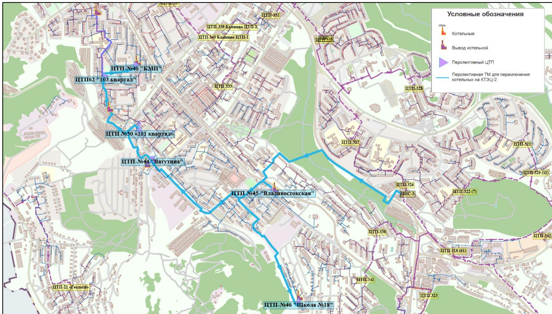
Рисунок 2.4 – Предлагаемая трассировка тепловых сетей для переключения котельных №40 «КМП», №44 «Ватутина», №45 «Владивостокская», №46 «Школа №18», №50 «101 квартал» и №62 «103 квартал» на КТЭЦ-2 по основному варианту 2
