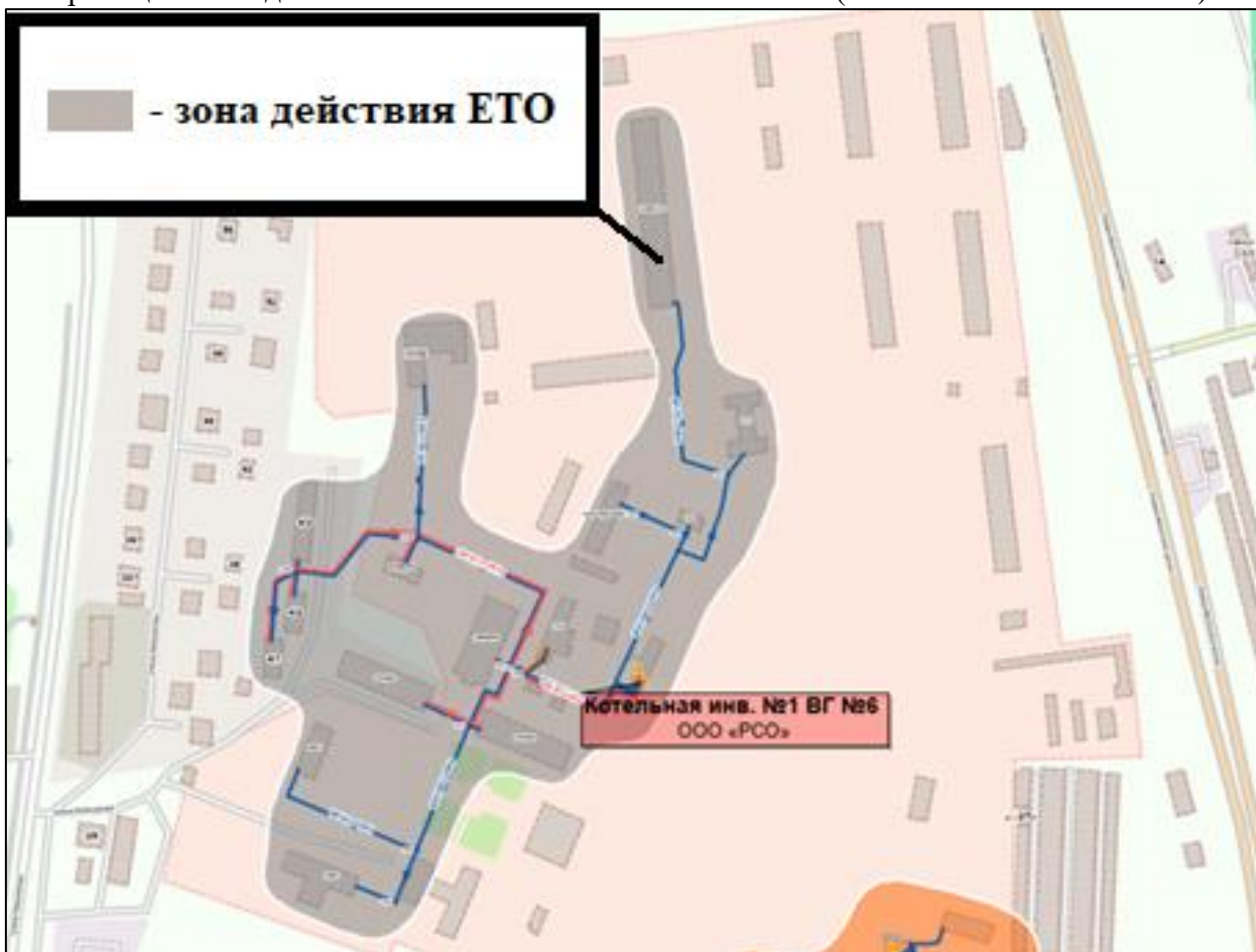
Рисунок 5.39 – Зона деятельности ЕТО № 05 (ООО «PCO») в границах зоны действия системы теплоснабжения № 39 (ИТЭ: Котельная ул. К. Маркса, военный городок №6)
