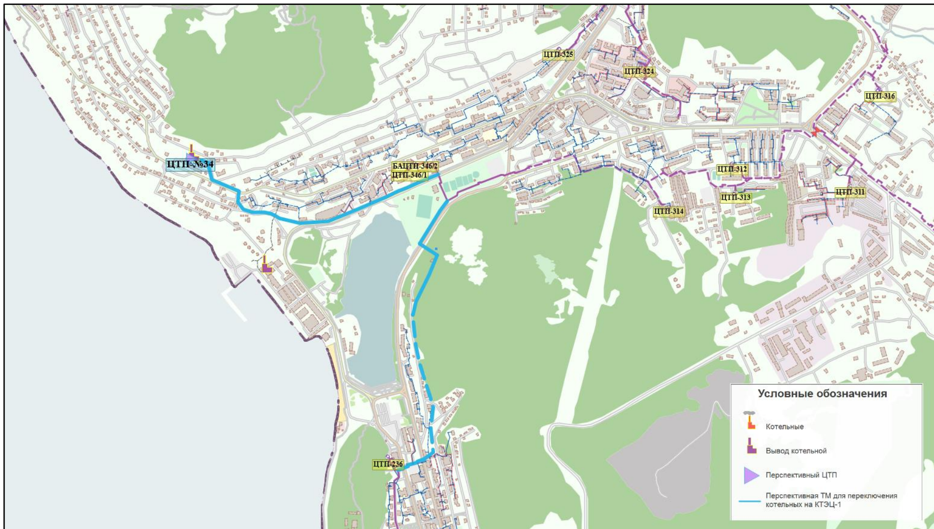
Рисунок 2.5 – Предлагаемая трассировка переключения потребителей котельной №34 «Электрокотельная» на тепловые сети КТЭЦ-1, а также трассировка перемычки между магистральными тепловыми сетями КТЭЦ-1 и КТЭЦ-2
